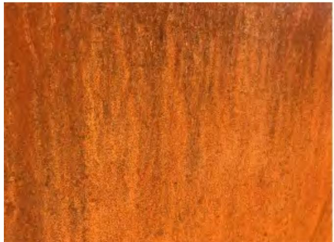
Edelrost kann auf allen Stählen entstehen... Sozusagen ist dieser erst der zweite Schritt, zuerst kommt die Auswahl des Materials... Normaler „Bau“-Stahl oder Cortenstahl... Beides ist hübsch, die Haltbarkeit ist unterschiedlich, der Preis sogar sehr unterschiedlich? Corten kostet fast das doppelte... Was bekomme ich neben der theoretischen“ langen Haltbarkeit denn noch dazu? **Gratis Schwermetalle Chrom, Kupfer und Nickel...**
